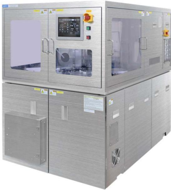
マイクロLED製造工程のPRアッショング用途として、洗浄装置(UV-300HC)を販売。
