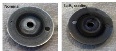
図 1 2 ノミナル（左）と提案モデル（右）のノズル内面の外観比較
