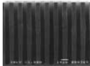
溝幅4 \mu m 深さ80 \mu m レート1.0 \mu m/min
