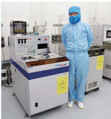
1991年からご使用いただいているRIE装置「RIE-10N」。現在も現役で稼働している。
