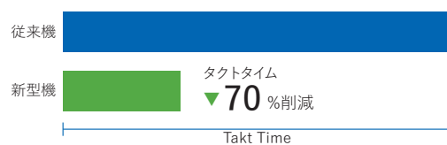
図3 従来機と新型機(リモートプラズマオプション)のタクトタイム比較
