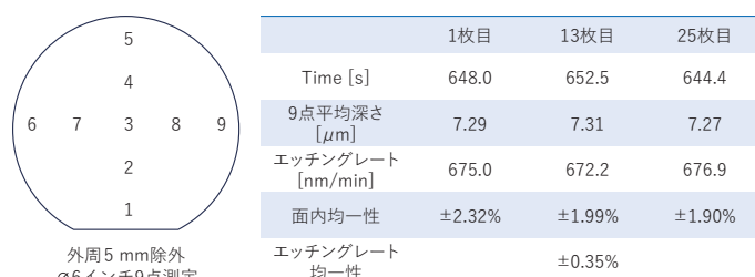
図4. ウエハ1枚目、13枚目、25枚目の面内均一性とエッチングレート確認結果
