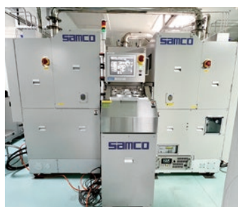
IIT Delhiに納入、現在昼夜稼働中のタンデム型薄膜太陽電池向けのマルチチャンバープラズマCVD装置「PD-2203L」
