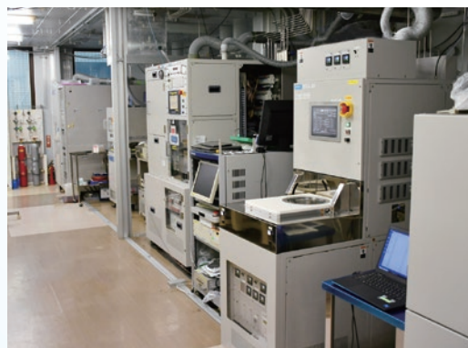
写真手前より アノード/カソード切り替えプラズマCVD装置「PD-200STL」 ICPエッチング装置「RIE-101iPH」 平行平板型ドライエッチング装置「RIE-10NR」「RIE-10NRN」 液体ソースCVD装置「PD-100ST」
